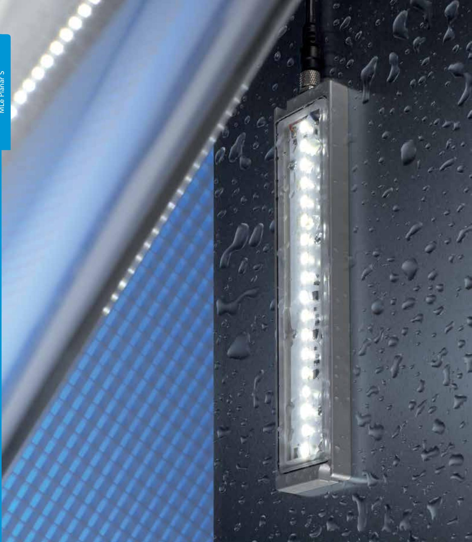
Die MLe Planar S200 ist eine Sonderbauform der MLe Planar. Die LED-Maschinen- und Arbeitsplatzleuchte hat eine sehr flache Bauhöhe. Die Lichtabdeckung ist ausschließlich aus klarem ESG erhältlich. Die MLe Planar S200 ist staubdicht, bietet vollständigen Schutz gegen Berührung sowie Schutz gegen zeitweiliges Untertauchen (Schutzart IP67).
