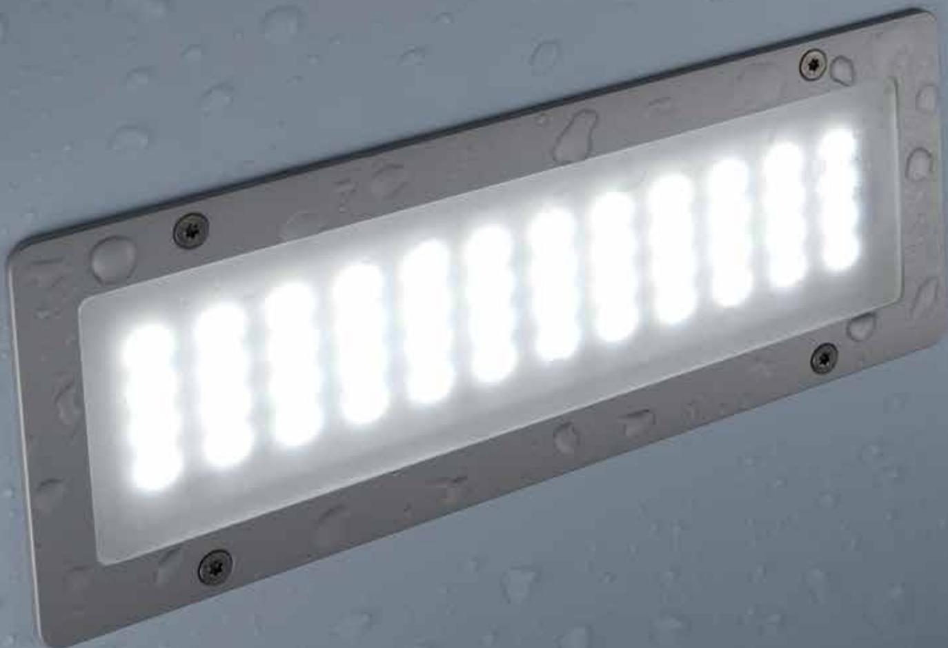
Die MLe Planar FL ist die Einbauvariante der MLe Planar. Die LED-Maschinen- und Arbeitsplatzleuchte zeichnet sich durch eine besonders geringe Aufbauhöhe von nur 3 mm im eingebauten Zustand aus. Die LED-Leuchte ist in zwei unterschiedlichen Längen und mit drei verschiedenen Abdeckungen lieferbar. Die MLe Planar FL ist staubdicht, bietet vollständigen Schutz gegen Berührung sowie Schutz gegen zeitweiliges Untertauchen (Schutzart IP67).
