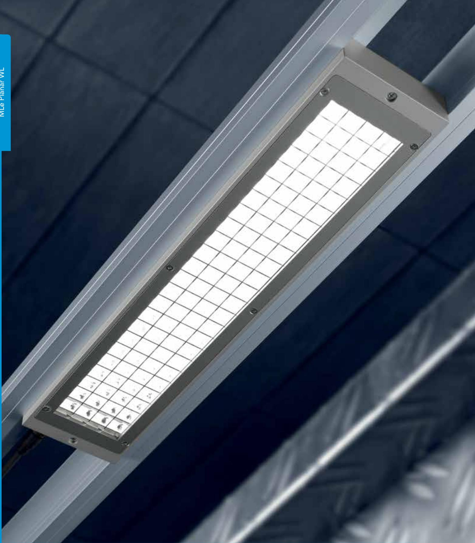
Die MLe Planar WL ist eine Rasterleuchte in LED-Technik. Das verspiegelte Lichtraster bietet ein sehr homogenes blendfreies Licht und macht die LED-Leuchte zur idealen Arbeitsplatzleuchte. MLe Planar WL ist mit einem Stufenschalter ausgestattet und kann auf eine Lichtleistung von 10 Watt oder 30 Watt eingestellt bzw. ausgeschaltet werden.
