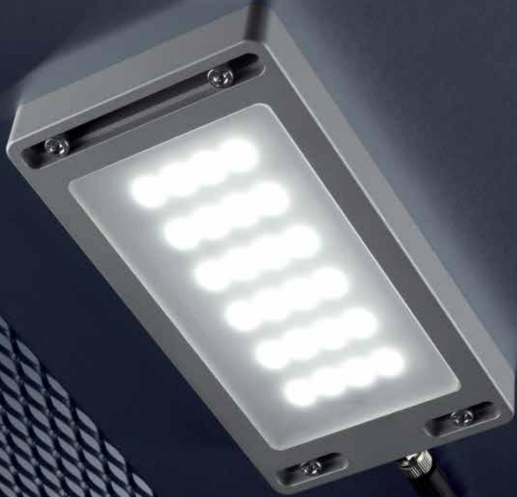
Die MLe Planar ist eine besonders flache LED-Maschinen- und Arbeitsplatzleuchte. Die LED-Leuchte ist in vier unterschiedlichen Längen und mit drei verschiedenen Abdeckungen lieferbar. Die MLe Planar ist staubdicht, bietet vollständigen Schutz gegen Berührung sowie Schutz gegen zeitweiliges Untertauchen (Schutzart IP67).
