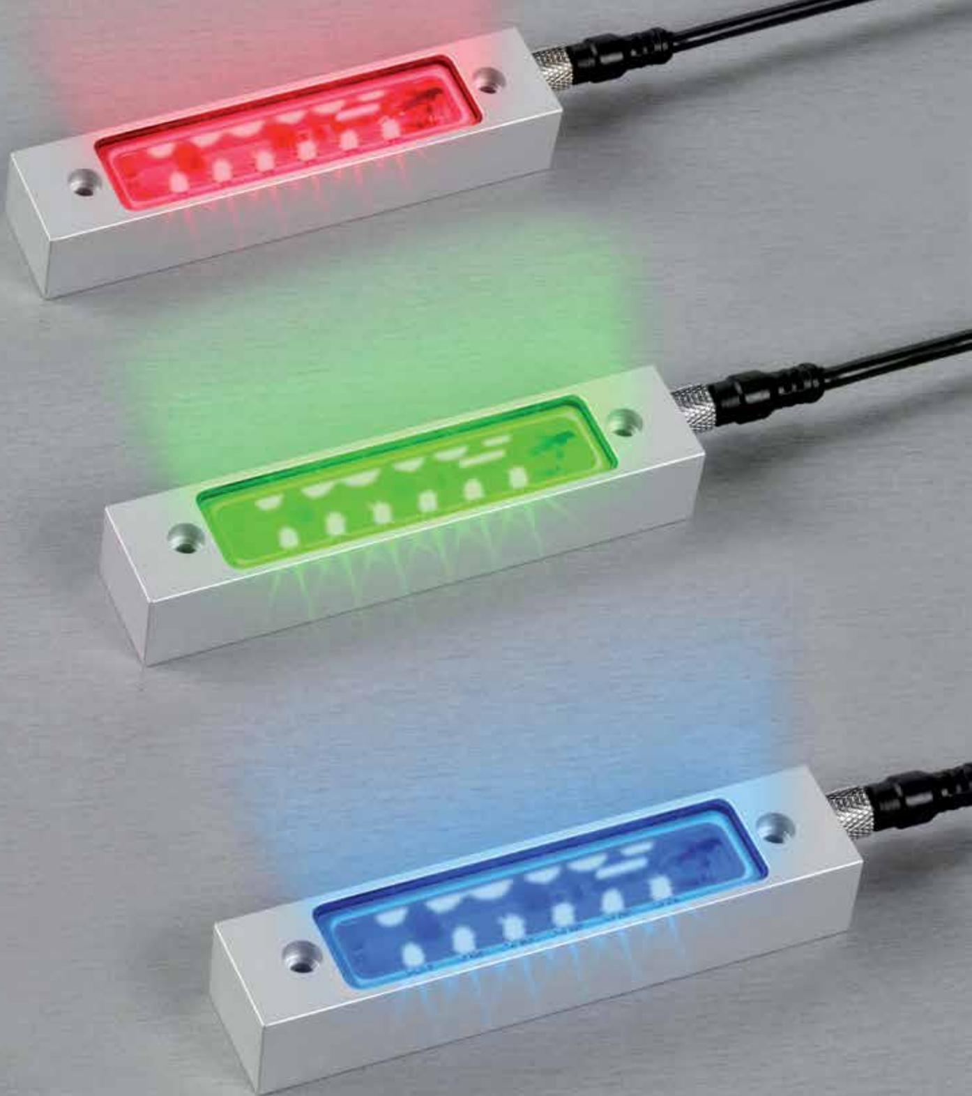
Die MLe Compact RGB ist eine Variante der MLe Compact. Als LED-Signalleuchte kann sie zum Beispiel verschiedene Maschinenzustände und Produktionsschritte durch unterschiedliche Farben anzeigen. Die LED-Leuchte ist mit drei verschiedenen Abdeckungen lieferbar. Die MLe Compact RGB ist staubdicht, bietet vollständigen Schutz gegen Berührung sowie Schutz gegen zeitweiliges Untertauchen (Schutzart IP67).
